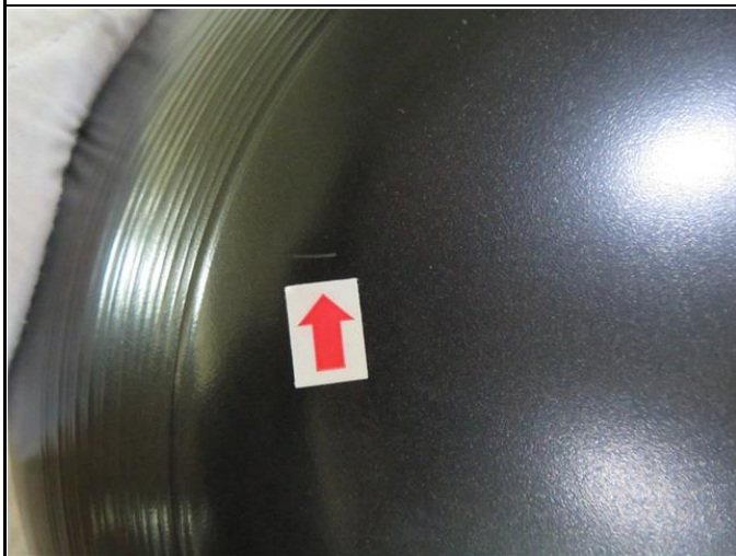
缺陷-底部凹坑
