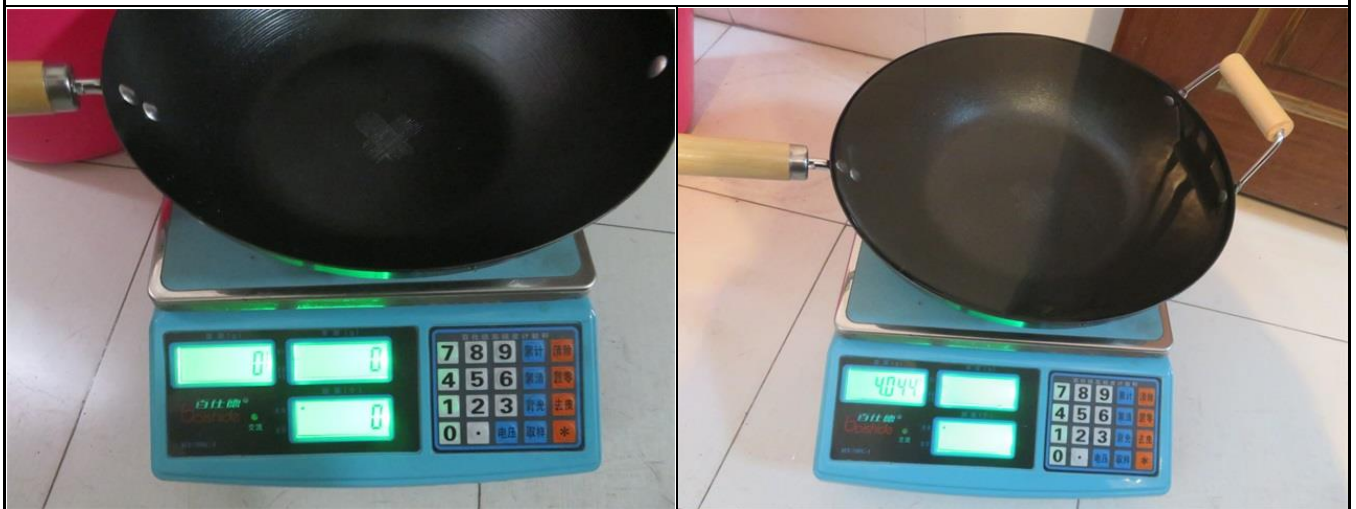
容量+铆钉漏水测试-4L
