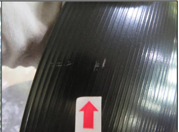
缺陷-底部凹坑
